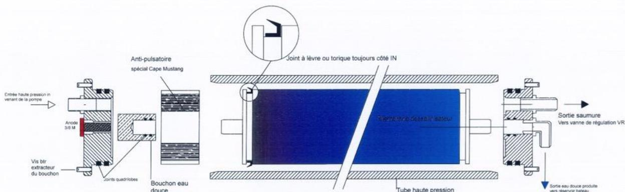
Schéma montage membrane dans tube dessalinisateur Cape Mustang version Explorer
