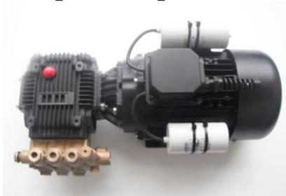
La pompe haute pression à pistons en céramique est entraînée par un moteur électrique refroidi par de l'eau de mer filtrée par les cartouches, toutes les impuretés de taille supérieure à 0,005 mm ont été retenues par les filtres
