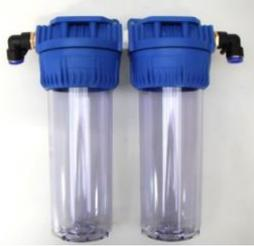
Le porte bi-filtre (N°4) comprend un premier filtre équipé d'une cartouche filtrante d'une longueur de 10 pouces et d'une filtration de 20 microns, et le filtre (N°5) équipé d'une cartouche filtrante de 10 pouces avec une filtration 5 microns.
