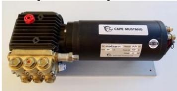
La pompe haute pression triplex à pistons en céramique est entraînée par un moteur électrique filtrée par la cartouches 5 microns, toutes les impuretés de taille supérieure à 0,005 mm ont été retenues par les filtres.
