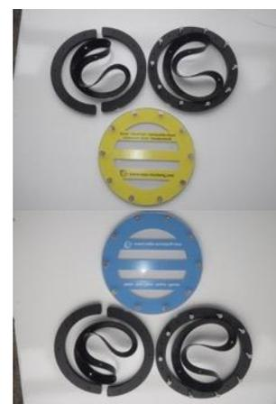
Trappe ou nable en aluminium marine (Type 1 / 2 et 3) parfaitement étanche, joints 2mm d'épaisseur résistant aux hydrocarbures, Trappe anodisée, couleur gris (ton variant en fonction des bains, fermeture par vis BTR inox diamètre 5mm A4, têtes fraisées.
